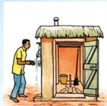
Dans une latrine lavable munie d'un toit, d'une porte et d'un dispositif LMS
